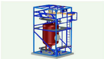
高压电极锅炉
